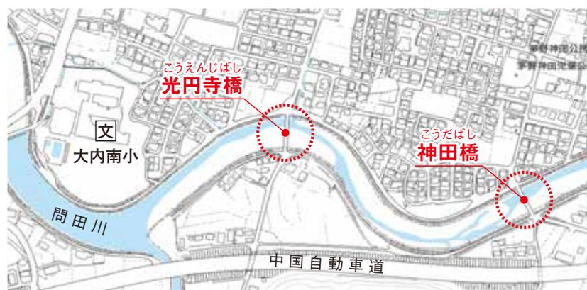
橋」については、令和6年度に完成する予定で、「面坊橋」については、令和7年度に完成する予定である。令和6年度から修繕に着手する橋梁は、宮野小学校近くの「初音橋」と、大内の「光円寺橋」、「神田橋」の3橋で、「初音橋」については昭和35年建設、「光円寺橋」と「神田橋」については昭和58年に建設されており、定期点検の結果、老朽化による損傷がみられることから、来年度より、複数年の工事となる見込みである。
